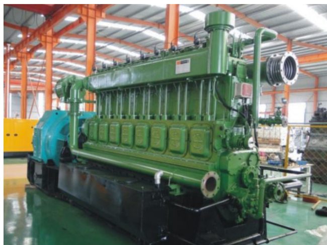
Рис 9. Газопоршневой двигатель работающий на горячем газе – синтез газе газификации твердых топлив
